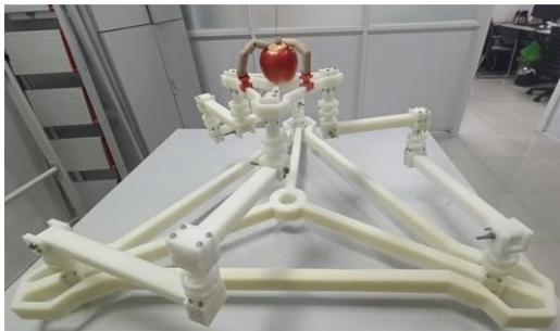
图 12 机械手抓取过程示意图
