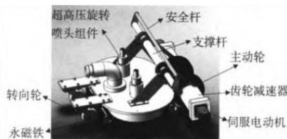
图 17 电机驱动式爬壁机器人
